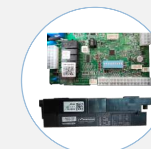
Плата управління з датчиками та DIP перемикачами
